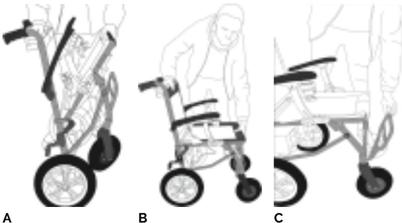
**A** Sobald Sie den Rollstuhl aus der Verpackung genommen haben, stellen Sie ihn auf eine stabile Unterlage. Legen Sie eine Hand auf die Oberseite der Rückenlehne und die andere Hand auf die Stange des Faltmechanismus unterhalb des Sitzes im vorderen Teil des zusammengeklappten Elektrorollstuhls.
