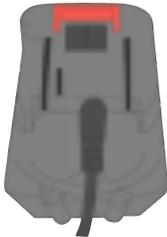
Bei einigen Modellen können Sie den Akku aufladen, ohne ihn aus dem Schacht auf der Rückseite des Steuergeräts zu entfernen, indem Sie das eFOLDi Ladegerät mit einem mitgelieferten Ladeadapter verwenden. **Benutzen Sie zum Aufladen KEIN anderes Kabel als das des 24 V DC eFOLDi Elektrorollstuhl-Ladegeräts.**
