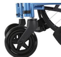
Abbildung 4 Korrekte Vorderrad Stellung nach vorne
