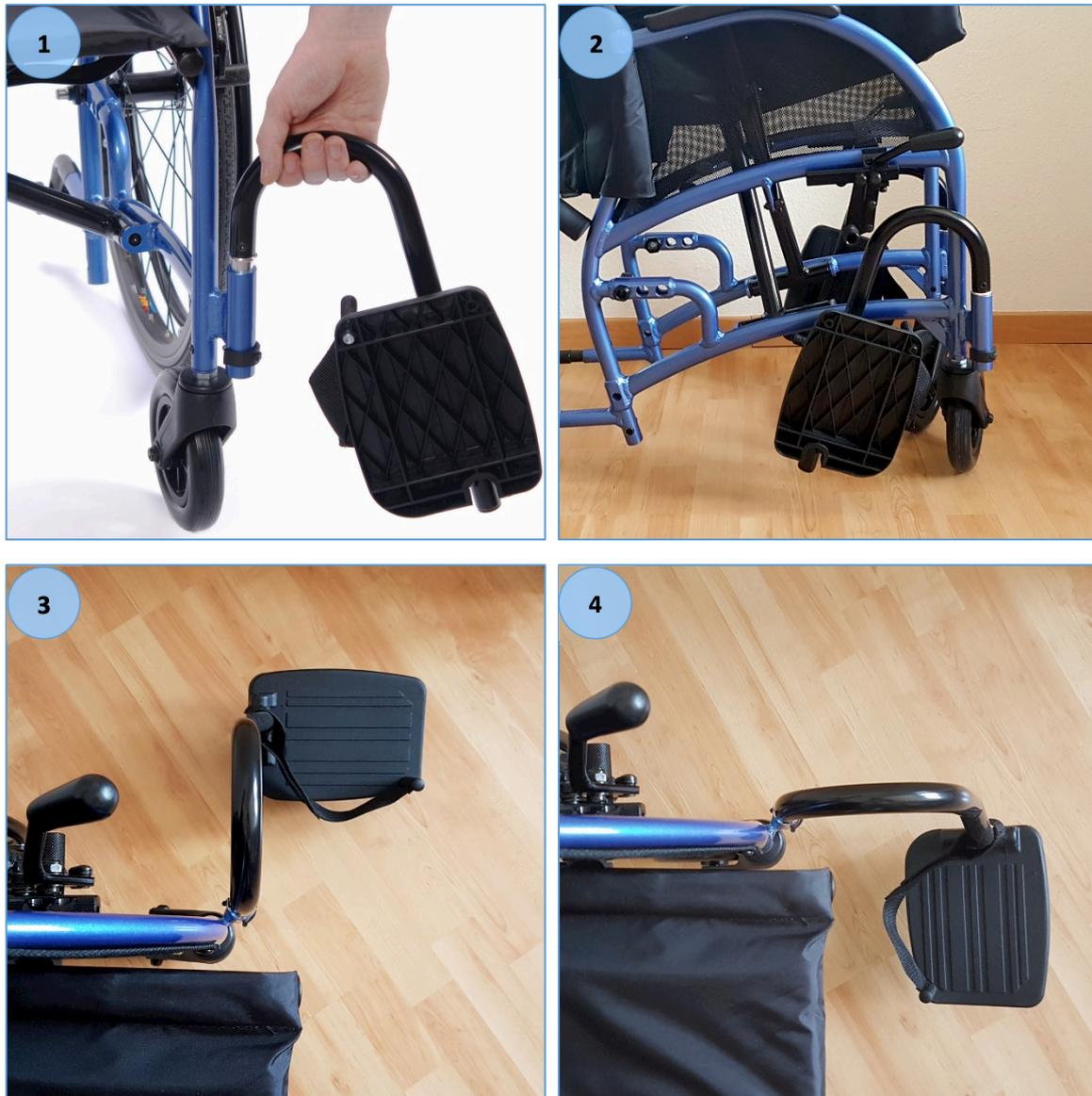
Die seitliche Einrastposition ist nur zur Verwendung zum Ein- und Aussteigen gedacht. Mit in dieser Position eingerasteten Fußstützen den Rollstuhl nicht fahren, um zu verhindern, an einem Hindernis hängenzubleiben.
