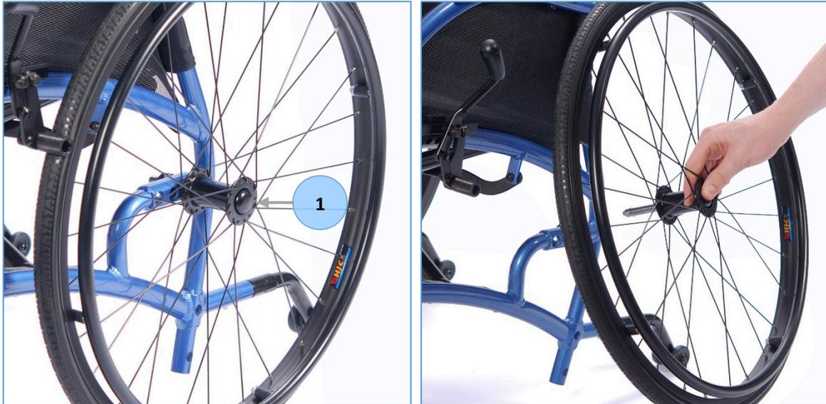
Beim Aufstecken ist die Achse in das Lager bei gedrücktem Knopf einzustecken. Knopf lösen, um die Achse zu fixieren. Der Arretierknopf muss in seine Ausgangsstellung zurückfedern.
