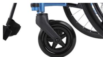
Abbildung 3 Nicht korrekte Vorderrad Stellung nach hinten
