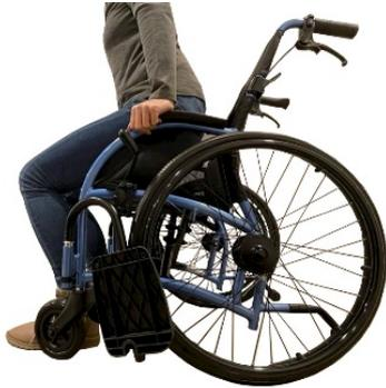
Abbildung 5 Korrekte Haltung – Schwerpunkt im Zentrum und Vorderräder nach vorne ausgerichtet.
