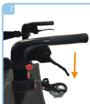
Zum Entriegeln der Bremse beide Bremsgriffe wieder nach oben ziehen bis sie entriegelt sind (Bremsgriffe sind in der mittlerer Position).
