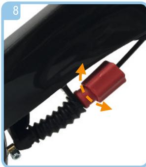
Bei schlechter oder zu harter Bremswirkung kann die Bremse an der Einstellschraube am Bowdenzug unten auf die gewünschte Bremswirkung eingestellt werden.
