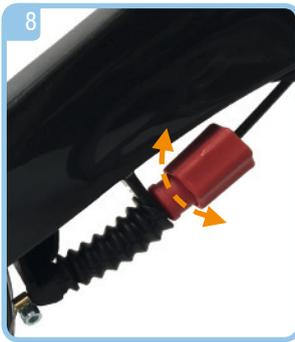
En cas de freinage trop faible ou trop brusque, le frein peut être réglé à la tension voulue au niveau du contre-écrou du câble Bowden vers le bas.
